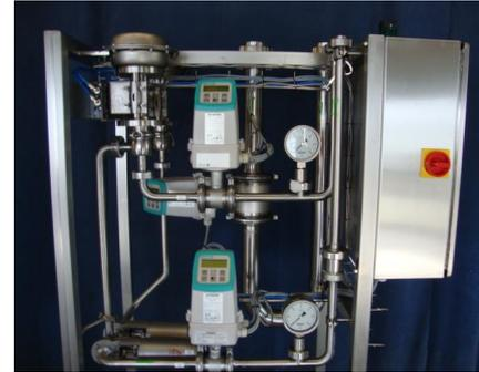
B) Estandarización - totalmente automática con flujómetro de masa y medición en línea. No es necesario para establecer el porcentaje de grasa entrante de la leche.
